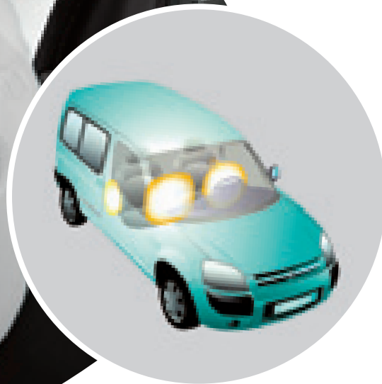
A frontális légszákok, az első ülések háttámlájába épített 18 literes oldallégszákok és az ajtómerevítők ütközés esetén hatékonyabb védelmet biztosítanak az utasok számára (felszereltség szerint).
